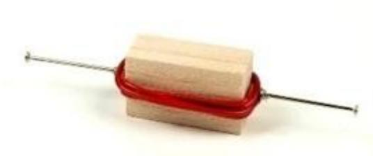
Ich habe die Spule in die Halterungen der Sicherheitsnadeln gelegt. Der Strom fließt durch den Motor und es kann dann drehen.
