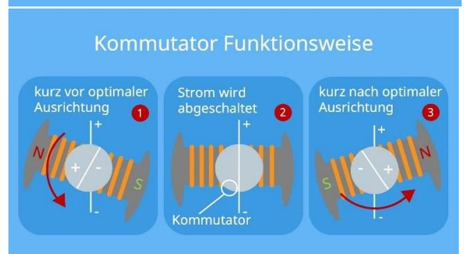
Wird nun ein Rotor über den Kommutator, an die Energiequelle angeschlossen und der Schalter geschlossen, bewegt sich der Rotor zunächst eine Vierteldrehung, bis die entgegengesetzten Pole von Rotor und Stator sehr nahe beieinander sind. Genau hier ist der Totpunkt des Elektromotors erreicht und der Kommutator sorgt für das Umpolen des Rotors, also ein Vertauschen der beiden Pole des Elektromagneten.
